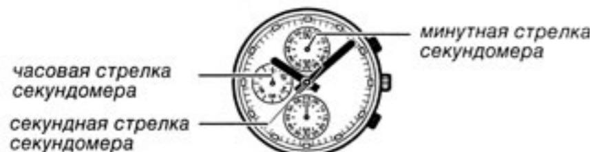
Секундомер позволяет отсчитывать время в пределах 11 часов 59 минут 59 секунд.
