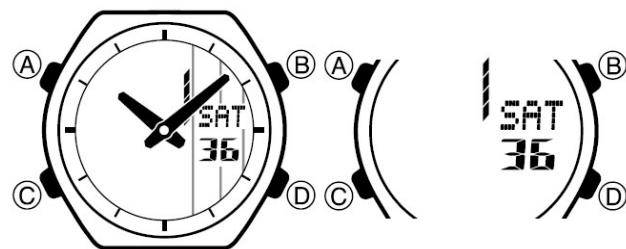
На рисунке изображен общий вид часов в Режиме Текущего Времени. Последовательное нажатие кнопки “C” обеспечивает переход из разряда в разряд в следующей последовательности: Режим Текущего Времени – Режим Мирового Времени – Режим Таймера Обратного Отсчета – Режим Секундомера – Режим Звукового Сигнала – Режим Аналогового Времени – Режим Текущего Времени.
