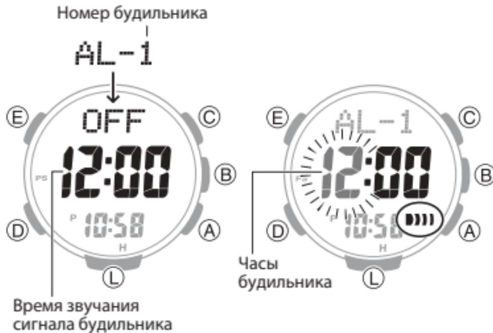
4. С помощью кнопок А и С выполните настройку часов звучания сигнала будильника.
