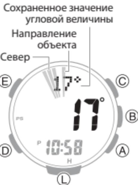
северу. Двунаправленная калибровка перед определения направления в местах, где действуют магнитные силы. Ее нужно выполнять, если часы по какой-либо причине намагничились и их показания отличаются от показаний, полученных с помощью другого компаса.
