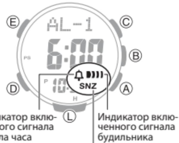
включенного сигнала будильника с повтором сигнала (SNZ) отображаются на экране во всех режимах.
