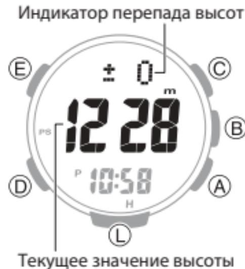
4. Сравнивая разницу высот, определенную с помощью карты, с показаниями часов, двигайтесь в сторону точки назначения.
