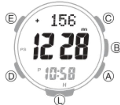
После перевода часов в режим Альтиметра, часы начнут измерять текущее значение высоты, затем текущее значение высоты отобразится на экране.
