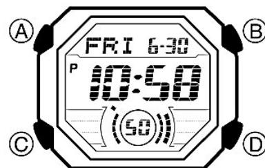
На рисунке изображен общий вид часов в Режиме Текущего Времени. Последовательное нажатие кнопки “C” обеспечивает переход из разряда в разряд в следующей последовательности: Режим Текущего Времени – Режим Секундомера – Режим Установленного Таймера Обратного Отсчета – Режим Таймера Обратного Отсчета – Режим Мирового Времени – Режим Звукового Сигнала – Режим Текущего Времени.
