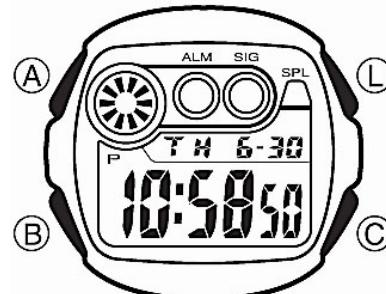
На рисунке изображен общий вид часов в Режиме Текущего Времени. Нажмите кнопку “B” для перехода из разряда в разряд в следующей последовательности:
