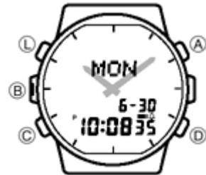
На рисунке изображен общий вид часов в режиме текущего времени. Нажмите кнопку "C" для перехода из режима в режим.
